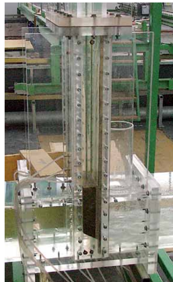
t Ensayo de modelo de las compuertas de bocatoma para la CH Tsankov Kamak, Bulgaria
