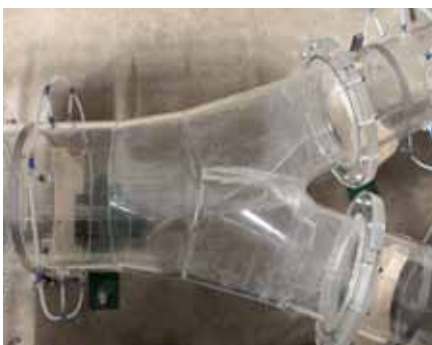
t Ensayo de modelo del bifurcador para la CH Pirris, Costa Rica
