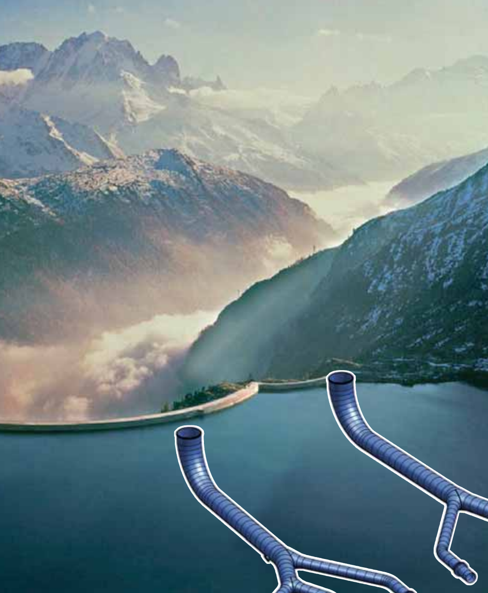
Vue en 3D des blindages des tunnels sous pression amont et aval ▶
