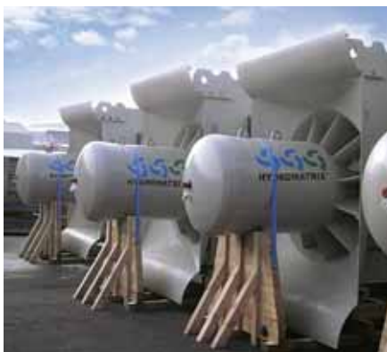
▲ Les unités de turbo-alternateurs HYDROMATRIX® avant leur installation sur le site d'Ashta, en Albanie
