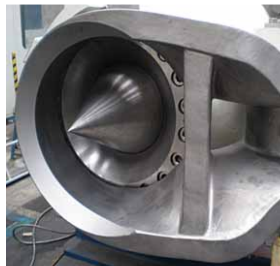
▲ Injecteur de Pelton avec le déflecteur
