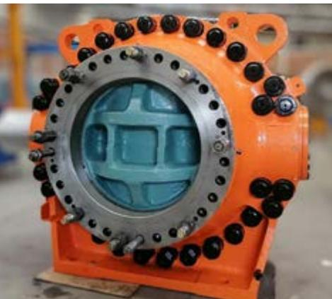
Central hidroeléctrica Guatapé, válvula esférica DN 1.100 fabricada originalmente en 1965 y rehabilitada por ANDRITZ Colombia en 2021.
