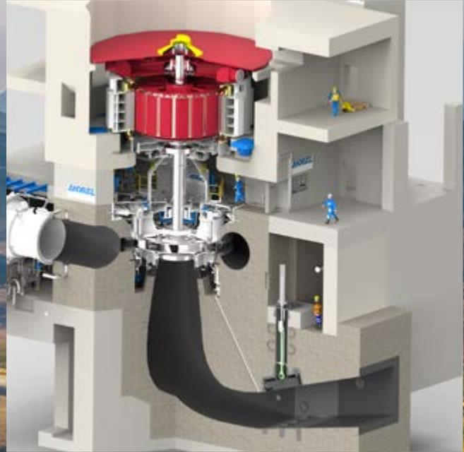
Representación 3D de una unidad de turbina-bomba que incluye motor-generador, turbina-bomba y válvula de admisión.
