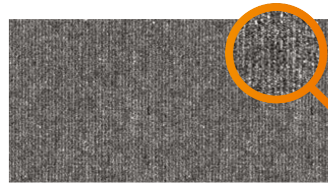
图7:传统成型网设计 样品:15克/平方米卫生纸(商品浆+脱墨浆)。车速:1,750米/分钟
