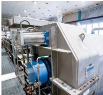
跟那两台双网压榨机一样, Holmen Hallsta纸厂回用了一台二手的安德里茨螺旋压榨机来提升PM12浆料的洗涤效果。
