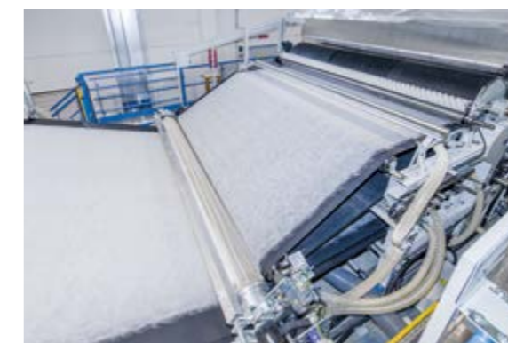
纤网成型: 工作幅宽为3.5米的eXcelle 梳理机
