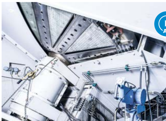
水平喂料削片机配备了成熟的TurnKnife TK-IV可翻转飞刀系统和QuickClamp快速换刀液压机构，以使换刀工作更快速安全。
