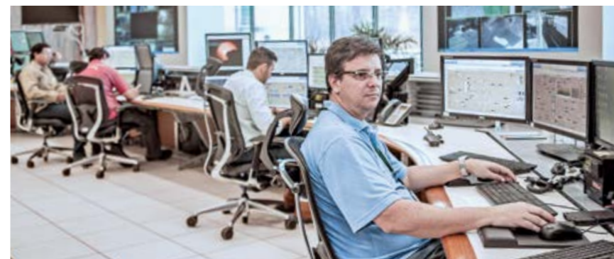
Eldorado的控制室是控制生产的执行中心。OPP软件连接DCS实现对纤维产线的高级控制,还将过程、维护和资产管理信息连接到同一网络中。
