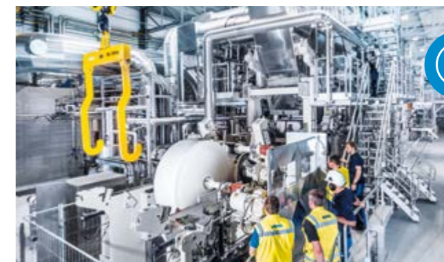
位于奥地利格拉茨的安德里茨卫生纸实验工厂PrimeLine TIAC，目前配置了PrimeLineTex卫生纸机，为客户测试和开发未来的纹理卫生纸。
