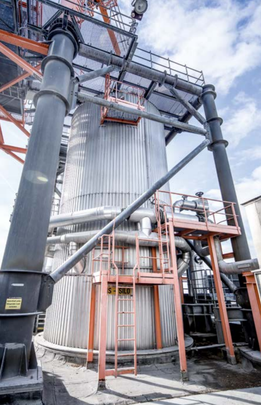
配备中心汽蒸、改进过的HELP™木片仓出料带来出色的预浸效果。
