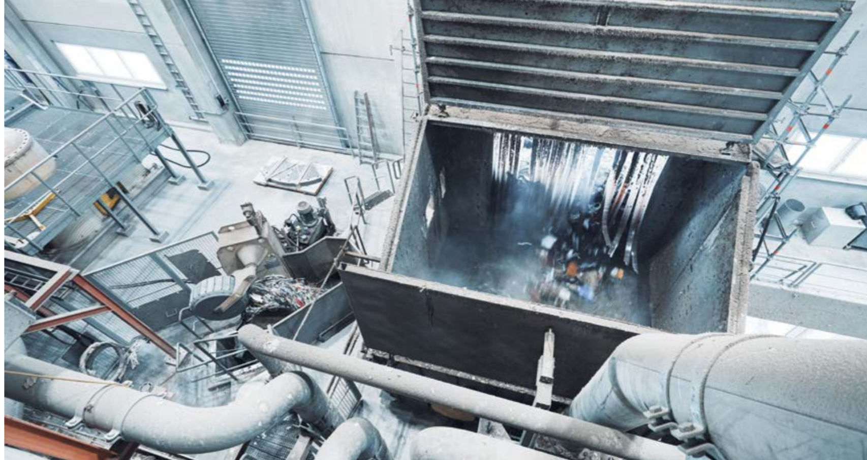
之前的粉磨设备改造成日能力为1,350吨的RCF生产线。配有一台安德里茨FibreSolve处理系统的FSR碎浆机，可确保原材料变成最佳浆料。
