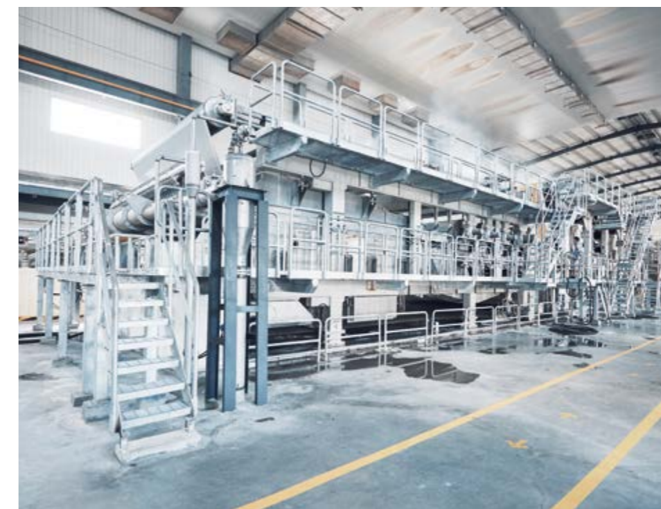
浆板机供货包括双网压榨浆板机、气垫干燥箱、切纸机和打包线。
