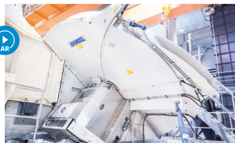
EXL型号的水平喂了削片机是世界上最大的削片机，配备18把飞刀，确保原木可以连续在高产能下产出高质量木片。
