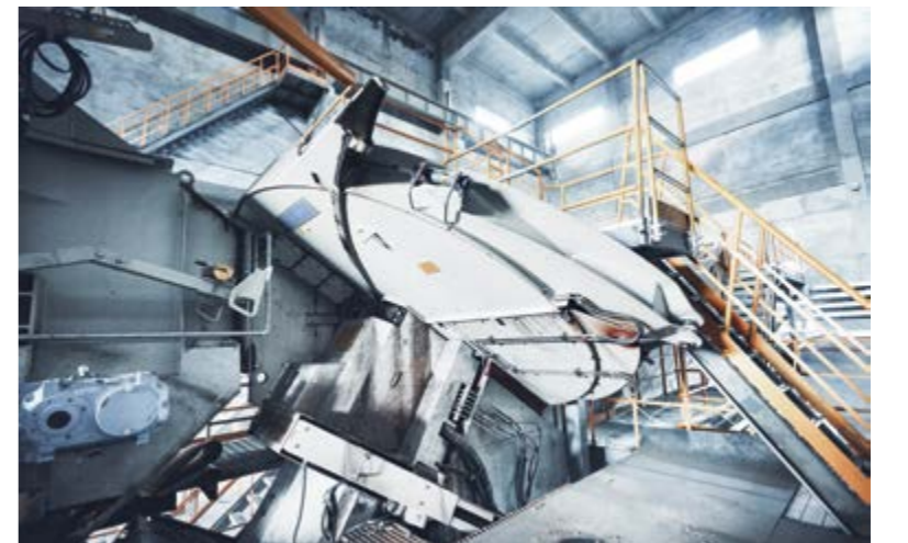
HHQ型水平喂料削片机具有独特的切削几何角度，可以在最高产能下生产质量超好的木片。
