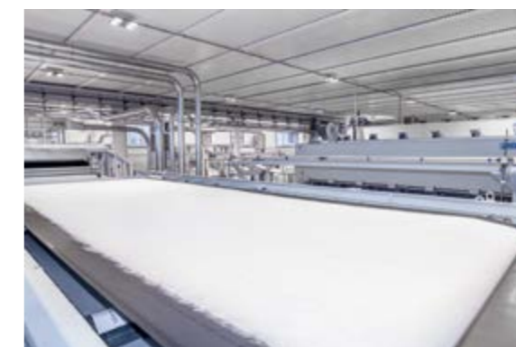
带ProDyn和Isolayer系统的Profile的交叉铺网机, 用于改善重量均匀度
