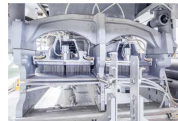
针刺机: 针板气动锁止系统
