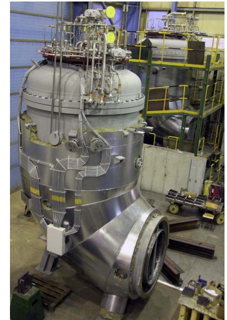
Gázturbina gázélegető kamra
