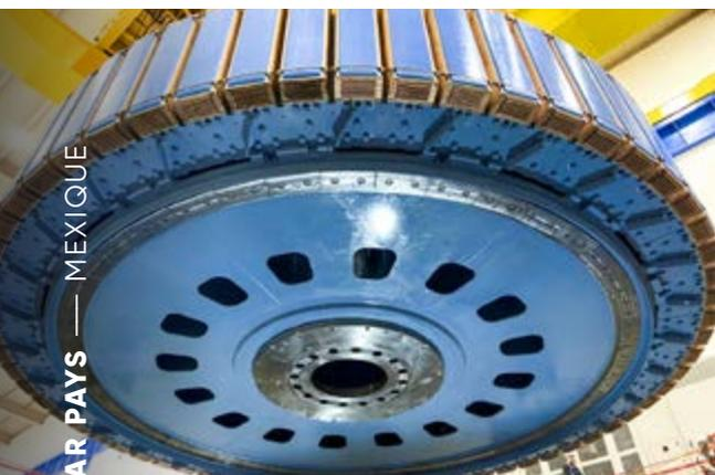
Stator de l'alternateur de la centrale hydroélectrique de Peñitas
