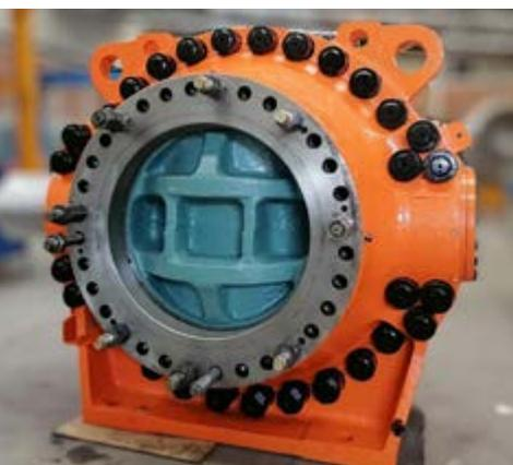
Centrale hydroélectrique de Guatapé, vanne sphérique DN 1100 fabriquée en 1965 et réhabilitée par ANDRITZ Colombie en 2021.
