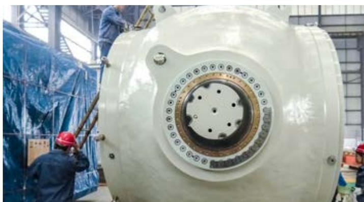
Inspection de la vanne d'entrée principale de la centrale hydroélectrique de Coca Codo Sinclair
