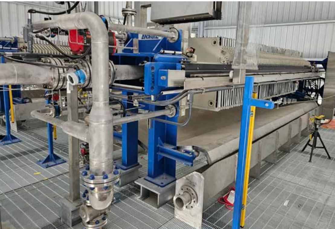
Die vielseitige Schlammentwässerungsanlage von Veolia ist mit Filter- und Schneckenpressen von ANDRITZ ausgestattet, die eine effiziente Aufbereitung von Schlämmen unterschiedlicher Zusammensetzung ermöglichen.
