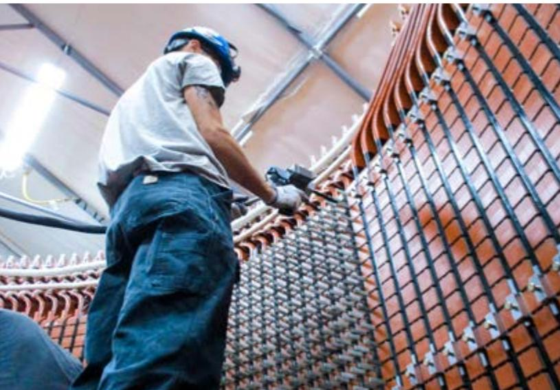
Controle e limpeza do empilhamento do estator do gerador, usina hidrelétrica de Collierville
